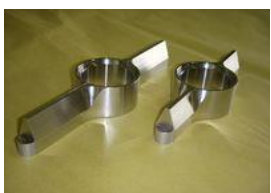
食品関係部品 ステンレス板材からの削り出し (一品もの)
