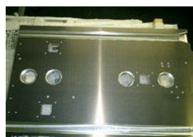
専用機部品 アルミ板材からの加工 (少量リピート品) 600 x 1,700
