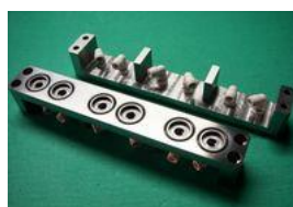
専用機部品 板材からの削り出し(一品もの) O-リング、コネクタ、組立まで
