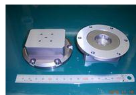
専用機部品 SUS440C 焼入れ HRC57 平行・直角度0.005以内
