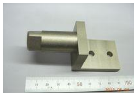
専用機部品 A7075 硬質アルマイト処理
