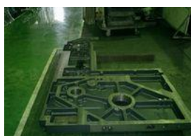
印刷機フレーム 鋳物材2 x 4m 少量多品種 (1ロット1~2台)
