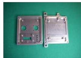
型部品 アルミ板材からの削り出し (一品もの) 三次元加工
